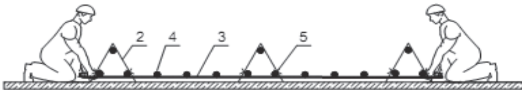
Установка каркасов поддерживающих верхнюю сетку
