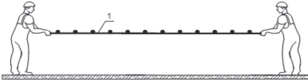
Установка нижних сеток
